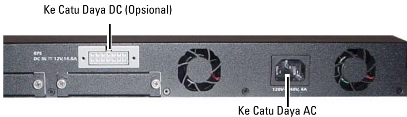
Gambar 1-15. Hubungan Daya AC dan DC ke Switch
