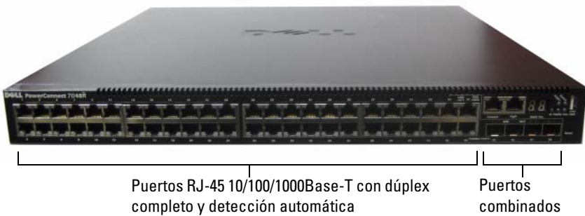
Ilustración 1-6. PowerConnect 7048R con 48 puertos 10/100/1000Base-T
