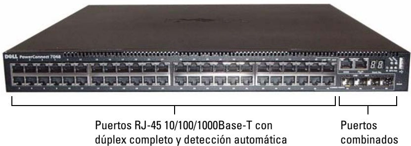
Ilustración 1-4. PowerConnect 7048 con 48 puertos 10/100/1000Base-T
